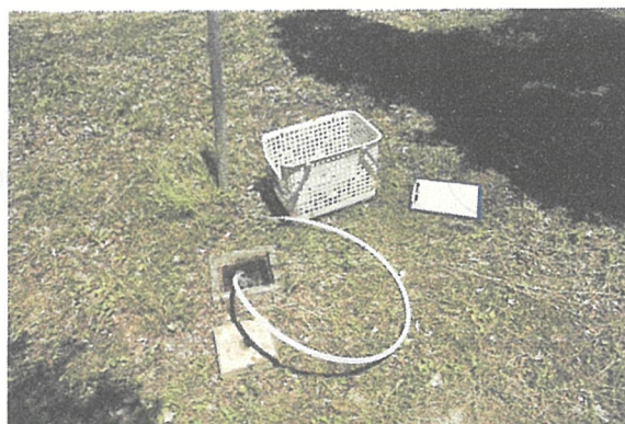
写真3-8 地点エの水位観測孔 No. A 地下水採水状況を示す。
