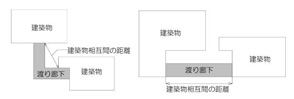
※建築物相互間の距離二渡り廊下の接続部を結んだ距離
