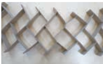
折りたたんだ状態のペーパーハニカム。広げると、写真上・下のように大きく広がります。
