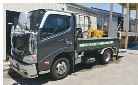
廃食油を燃料にして実際に油を回収しています。
