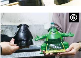
こまき山はソフト塩化ビニールを用いた小ロット生産です。熟練した技術が必要で、専門の業者が一つ一つ手作業で作っています。①こまき山の型に原料(ソフビ)を入れます。②原材料を脱泡しています。
