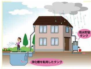
※1つの浄化槽で約1000ℓの雨水を貯めることができ、新川流域で今後10年間下水道へ接続する家庭で浄化槽を雨水貯留浸透施設へ転用すると、約5万㎡の雨水を貯留することができます。
