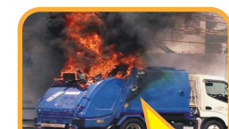
スプレー缶が 漏れていて 火事になった 写真
