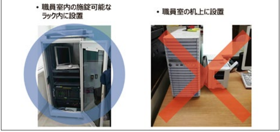
図表 15 学校内でサーバを設置する場合の設置事例
