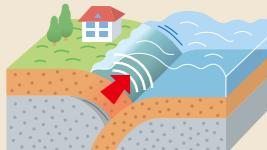
引きずり込みが進み、プレートが耐えきれなくなると陸のプレートは、元の形に戻ろうとしてはね返ります。このとき、発生するゆれが海溝型地震です。
